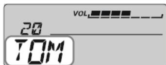
1. Для активации режима меню нажмите и удерживайте в течение одной секунды кнопку VOL\SEL. Если на экране отображаются часы, секундомер или температура, то нажмите кнопку VOL\SEL для перехода в режим VFO или режим памяти, а затем производите вышеперечисленные действия.
