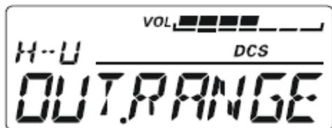
Если Вы покидаете зону «радиовидимости» более чем на одну минуту (четыре посылки), радиостанция воспримет отсутствие принимаемого сигнала, прозвучит три звуковых сигнала и на экране отобразится надпись «OUT. RANGE». При возвращении в зону «радиовидимости» на экране появится надпись «IN.RANGE»
