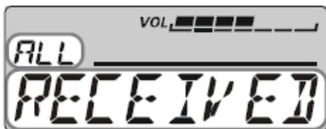
5. Затем удаленная радиостанция автоматически отключается и включается снова, после чего переходит в режим VFO или обычный режим памяти.
