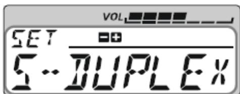
1. В режиме VFO настройте необходимую частоту передачи. (Частота передачи должна быть в том же диапазоне, что и частота приема).
