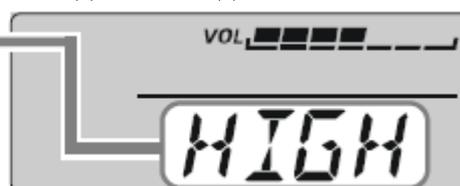
3. Через две секунды после выбора уровня мощности новая установка автоматически сохраняется, а радиостанция возвращается в режим VFO и канала памяти.
