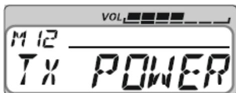
Радиостанция позволяет отдельно устанавливать уровень мощности передатчика для каждого канала памяти.
