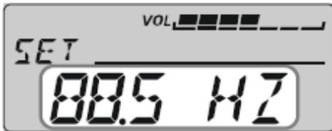
Радиостанция позволяет менять тоновую частоту CTCSS.
